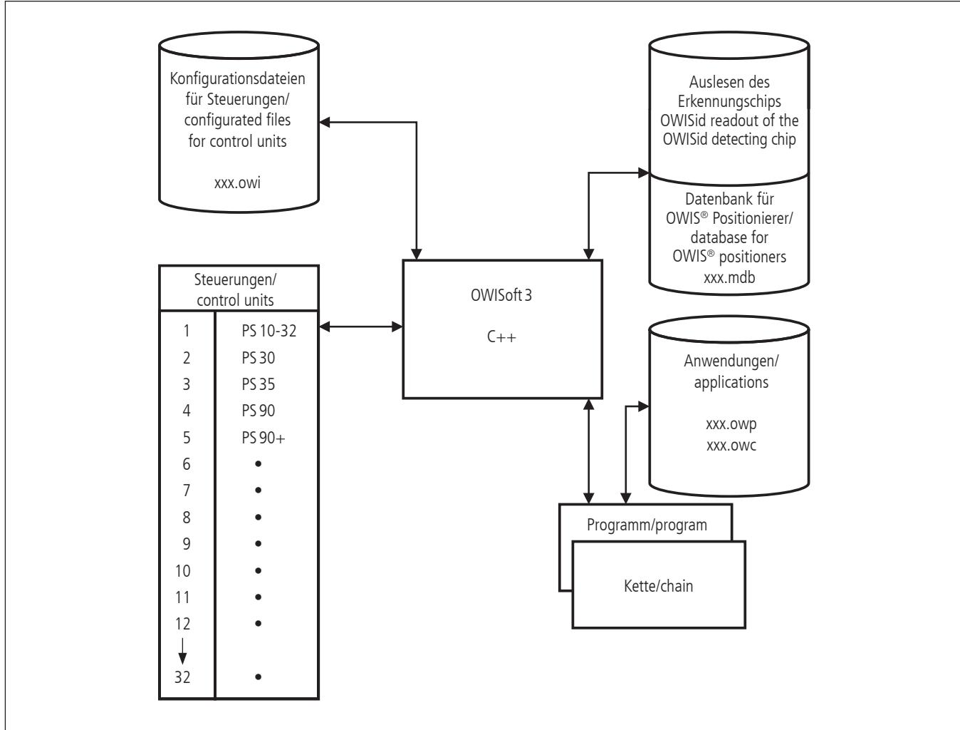
OWISoft 3.1 verfügt über zwei speicherbare Applikations-Oberflächen. Mit Kette wird in einer Tabelle ein einfacher, sequentieller Bewegungsablauf erstellt. Mit einem Assistenz-Programm können komplexe Bewegungsabläufe mit einer Skriptsprache erstellt, geprüft und ausgeführt werden.
