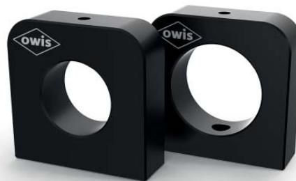
Gefasste Optiken, Einsätze und Justiereinsätze werden mit Hilfe der Halter für gefasste Optiken OH 25-D im Strahlengang fixiert. Für die Montage auf Reitern RT 25 haben alle OH 25-D Gewindebohrungen M2,5. Zusätzlich verfügen alle Halter über eine M4-Bohrung für die Montage auf Stiften.
