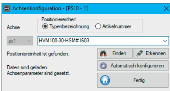
Zur Vereinfachung der Einstellung besteht die Möglichkeit, eine passende Positioniereinheit aus der fest definierten Programm-Datenbank (Taste „Finden“) oder aus dem OWISid (Taste „Erkennen“) zu übernehmen.
