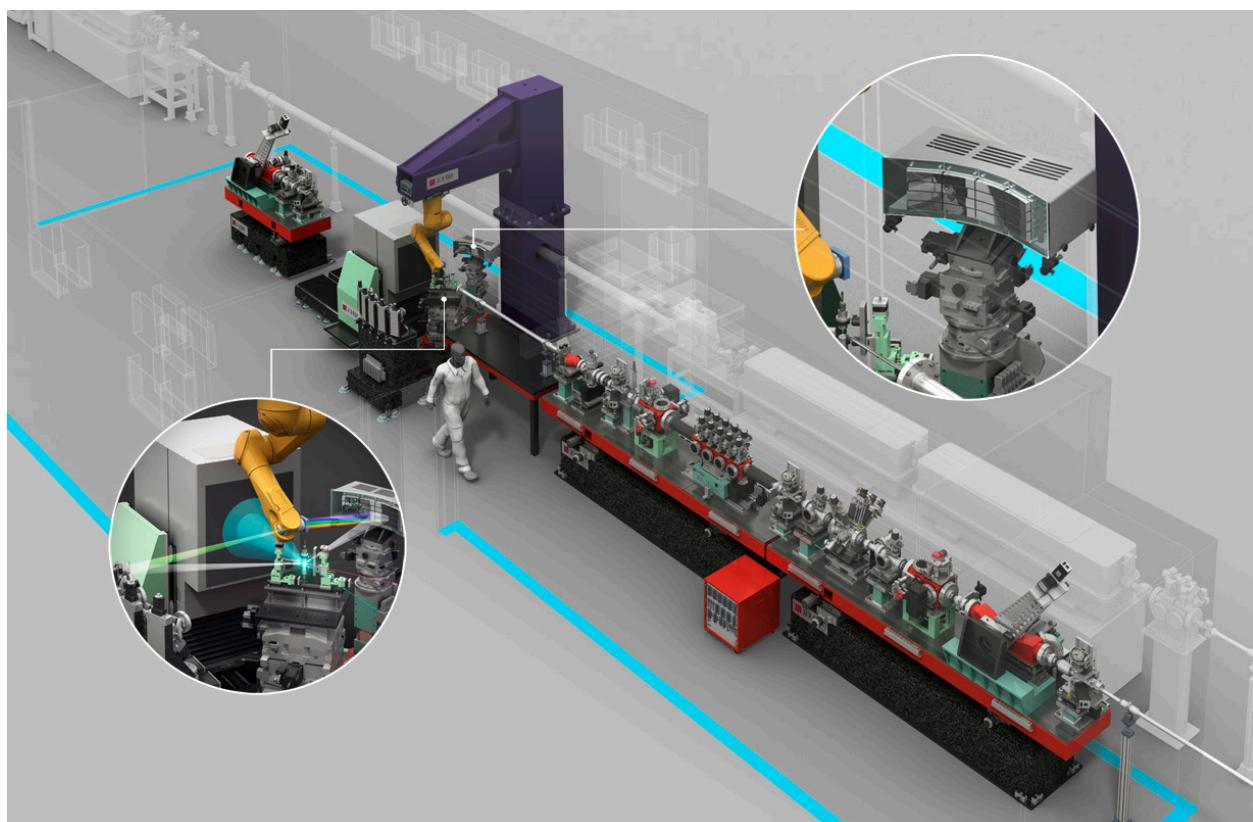
Jeweils drei unserer **MMS19 Stellantriebe** mit nicht drehender Spindel steuern je einen der 16 zylindrisch gebogenen Kristalle, die ein Röntgenemissionspektrum auf eine geeignete Kamera abbilden.
